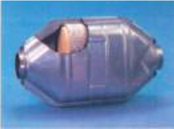
جوره بگورپکی هاندەر، که له ئۆتۆموبیلدا به کار دیت، پارچه یه کی لی بردراوه تاکو ئه و ماده سیرامیکه کونیلهداره دهریکه ویت که وهک بنچینه یه کی بگورپکه کار دهکات.
