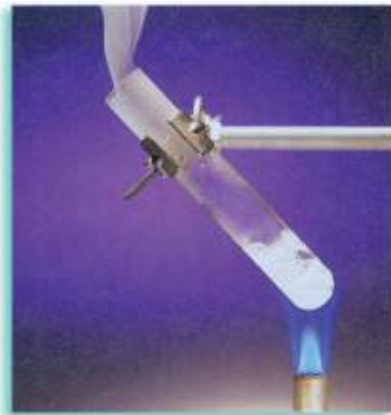
شیوه 6-5 که نیتراتی ئەمۆنیۆم \text{NH}_4\text{NO}_3 لیک هەڵدەوشێت، ئینترۆپی سیستمەکە زۆردەبیّت، چونکە (أ) کارلیککردوویەکی رەق دەگۆرێت بۆ (ب) دووبەر هەمەتووی گاز و یەکیکی رەق.
