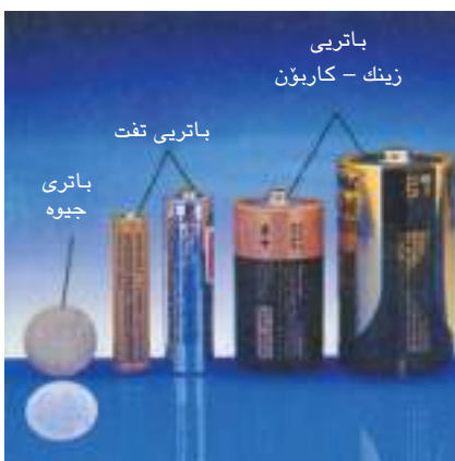
شیۆه 5-9 زۆرینهی باترییه باوهکان خانەى قۆلتایى ساده و وشکن.
