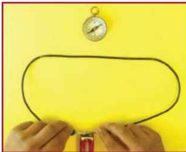
▲ كاتېك تەزۋى كارەبا بەوايەرەكەدا تېدەپەرت دەرزی قىبلەنماكه ئاراستەيەكى نۆيۈ وەردەگرېت.
